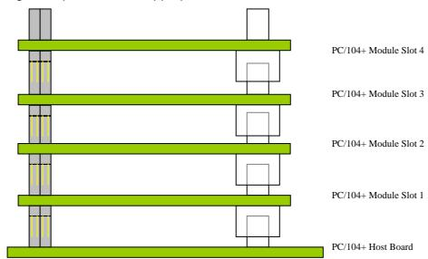
Figure 1 PC/104-plus module stack
